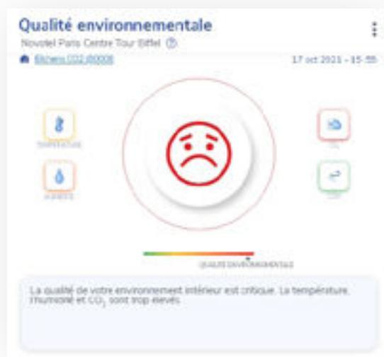
Dans cet exemple, la mesure du taux de COV est bonne, la température moyenne et l'humidité ainsi que le CO<sub>2</sub> sont mauvaises. Le score total de cette mesure est donné par l'icône et la barre horizontale en dessous.
